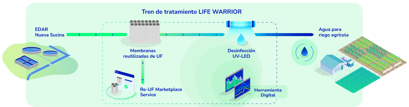
Gráfico 2. Proceso que se sigue en el tren de tratamiento de LIFE WARRIOR.
