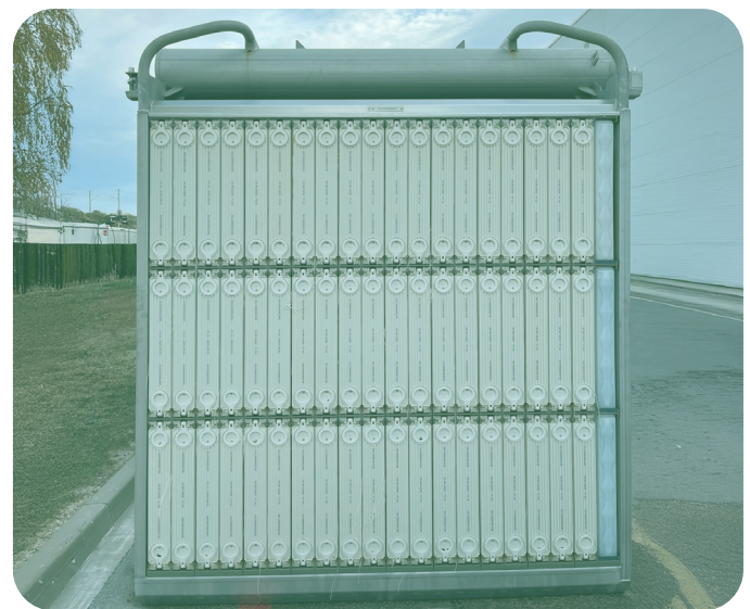
Imagen 2. Membranas de UF reutilizadas procedentes de la ETAP de Sant Joan Despí.
